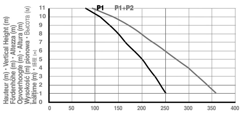
P1 Débit (l/min) avec 1 moteur • Flow Rate with 1 motor (l/min) • Flöde med 1 motor (l/min)
