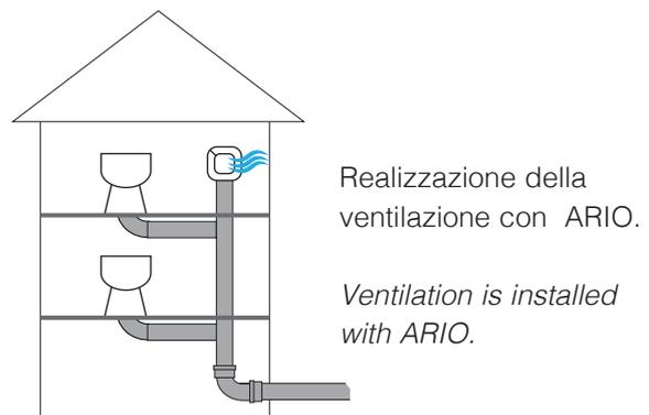
É possibile installare la presa d'aria all'interno del fabbricato, per esempio nel vano scala di un condominio, in quanto non abbiamo bisogno di disperdere all'esterno i cattivi odori.
