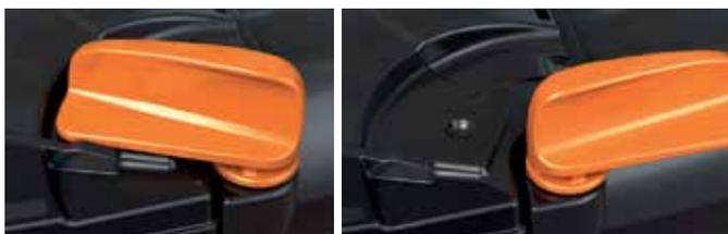
Otevření či uzavření víka klapky se provádí pootočením čtyř páček zámků poklopu o 90°. Není potřeba žádné nářadí. Polohy uzavřeno se docílí „zacvaknutím“ páček zámků v krajní poloze.
