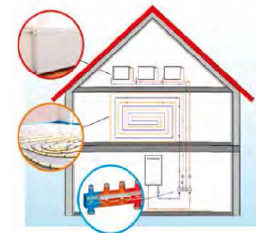
Obr. 41: Sinus MultiFlow Domestic v otopné soustavě rodinného domu
