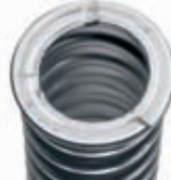
Špatně odřezaná trubka
