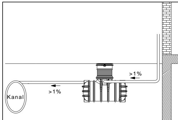
**Important :** La gaine PVC contenant le tuyau d'aspiration et les câbles doit être raccordée **au-dessus** du niveau max. de l'eau.
